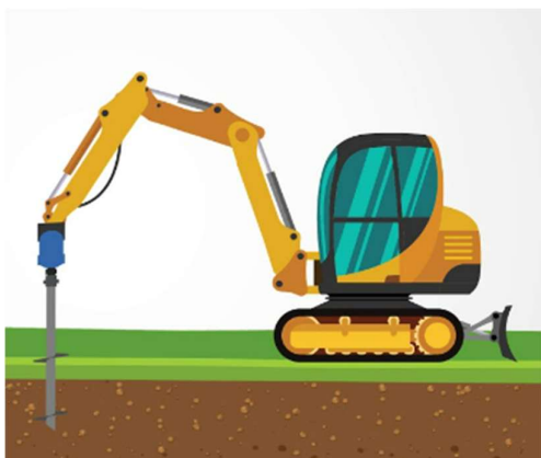
Figur 13, exempel på installation av markskruv med grävmaskin, samt Helical pålning med 2 kragar.
